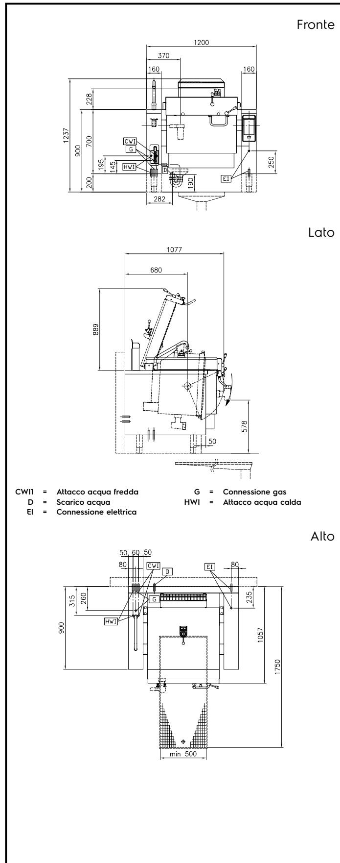
Brasiera a gas basculante a pressione, 90 lt. (h), con funzione condensa vapore e sonda di temperatura, carico automatico acqua calda/fredda con rubinetto, doccetta, kit di chiusura posteriore.
